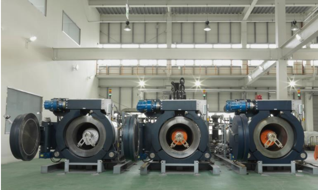
Görsel 2 DyeCoo firmasına ait susuz boyama sistemi [20]
