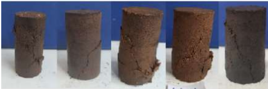
Görsel 8. Serbest basınç deneyinde kırılan bazı numune görselleri
