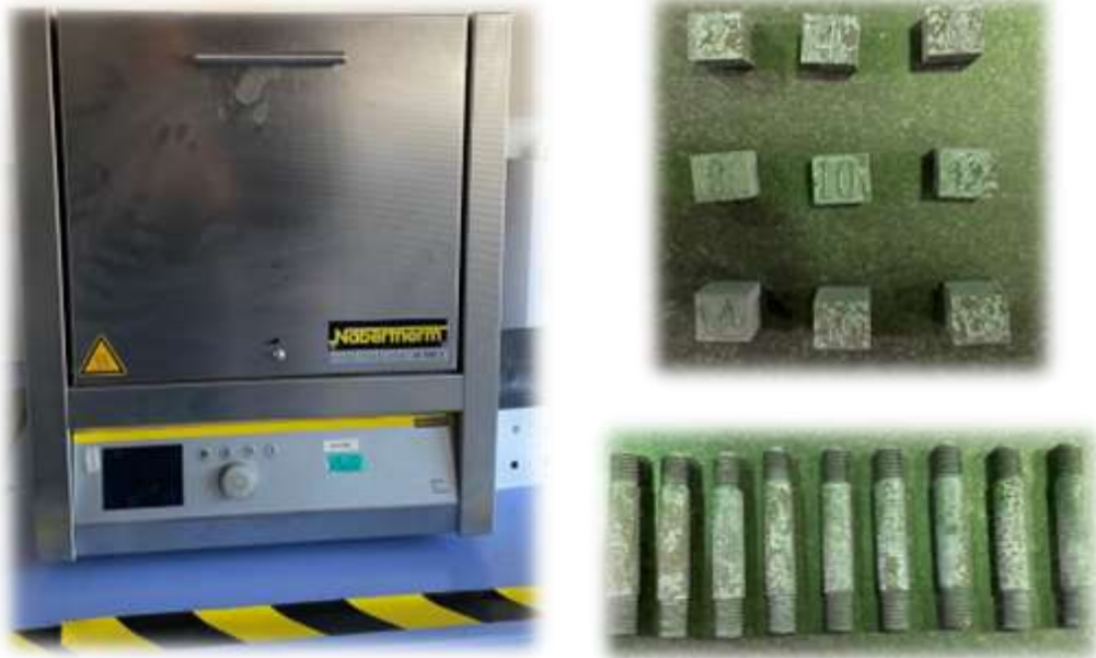
Görsel 4. Isıl işlem fırını ve ısıl işleme tabi tutulan parçalar
